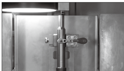
② 標準ゲージ(定期的に校正済)を用いての校正
